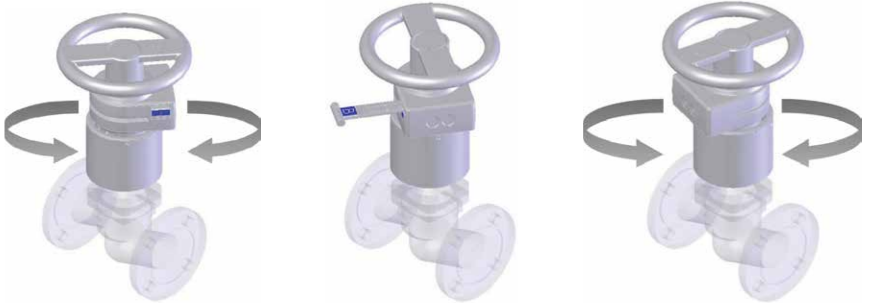
Schritt 1: Ohne den codierten Schlüssel lässt sich die AT frei drehen (Es besteht kein Kraftschluss zur Ventilspindel)
