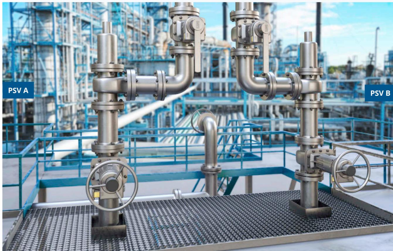
Cette réalisation des exigences de sécurité est illustrée dans notre séquence logique de clé. Grâce à la clé de démarrage A, conservée en toute sécurité dans la salle de contrôle, l'opérateur autorisé peut décider de la fermeture d'une des deux lignes. Cette clé est conçue de manière à pouvoir déverrouiller les deux vannes d'entrée des deux lignes PSV.
