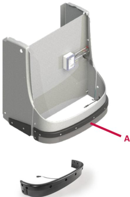
**Capteur [A]** Le capteur de zone fournit à l'unité de contrôle un signal qui change lorsqu'il est actionné (par pression). Le capteur de zone est muni d'un déflecteur frontal qui peut être ajustée en hauteur. Si e déflecteur frontal ou le capteur interne est endommagé, il peut être remplacé.
